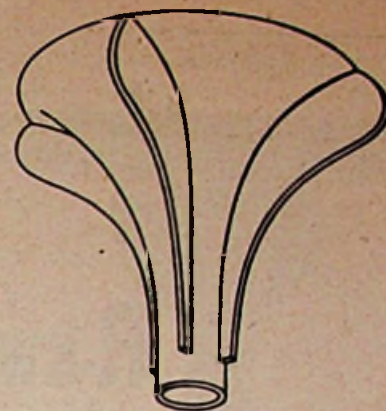
Metalen agitator; veroorzaakt een spoelende beweging van het wasgoed.
